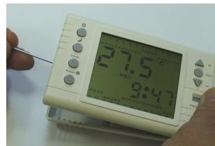
5.3. Разъедините две половины корпуса. В фасадной половине располагается батарейный отсек.
